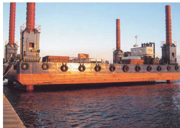
台船昇降装置 BARGE LIFTING EQUIPMENT
